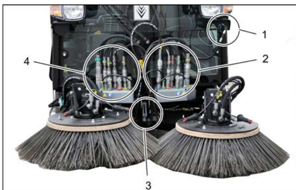
Εικόνα: συναρμολογημένο και συνδεδεμένο σύστημα σάρωσης στο MC 130
