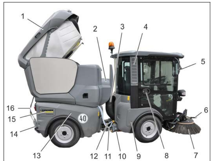
Figura: MC 130 com colector do lixo varrido levantado (lado do condutor)
