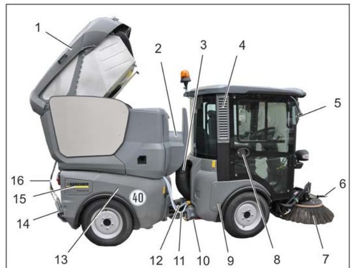
Abbildung: MC 130 mit angehobenem Kehrgutbehälter (Fahrerseite)
