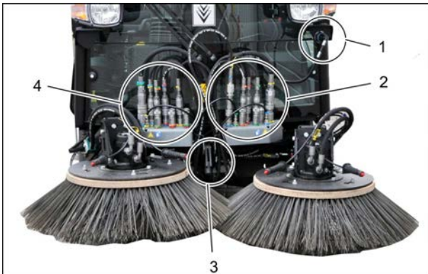
Abbildung: angebautes und angeschlossenes Kehrsystem an der MC 130
